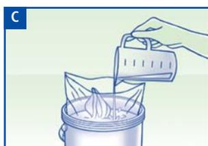
C Anwendungslösung (2,5 Liter) langsam spiralförmig von der Mitte nach außen über die Vliesrolle geben.
