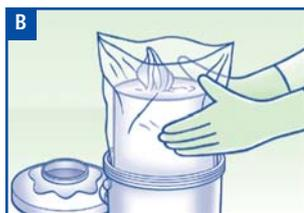
B Vliesrolle im Folienbeutel in das Spendergehäuse einsetzen, Folienbeutel öffnen, dabei den Anfang der Rolle ein kleines Stück aus der Mitte herausziehen.
