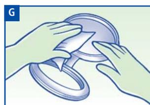
G Bei jedem Rollenwechsel ist der Deckelverschluss routinemäßig aufzubereiten. Wenn die Innenseiten des Spenders feucht/nass oder sichtbar verschmutzt sind, sind zusätzlich das Spendergehäuse und der Spenderaufsatz gründlich mindestens 30 Sekunden mit einem hochalkoholischen Produkt (wie z.B. Bacillol® AF) desinfizierend zu reinigen.
