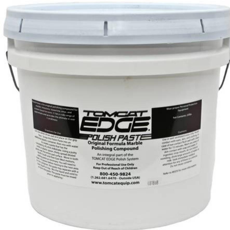
Die Marmor Paste dient der Herstellung eine Hochglanzbodenoberfläche . Die Marmorfläche wird mit der Marmorpaste aufpoliert. Die Paste muss nach dem Schleifgang mit der 800 Körnung aufgetragen werden. Als Treiber Pad wird das Mitnehmer Pad TC-EDGE-4025 eingesetzt.
