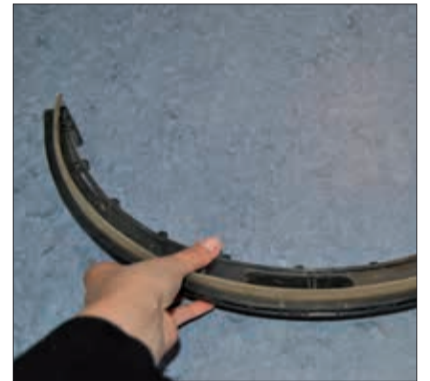
15. Überprüfen Sie die Sauglippen auf Beschädigung (ggf. austauschen).
