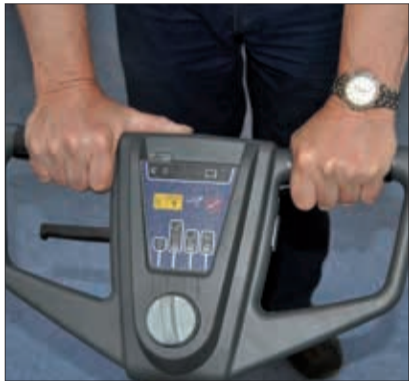
6. Betätigen Sie den roten Sicherheitsschalter zusammen mit den beiden Griff-Hebeln, um die Maschine zu starten. Der Sicherheitsschalter kann hiernach wieder losgelassen werden.
