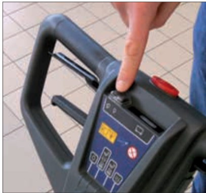
7. Wählen Sie die Wassermenge durch Drücken der Taste.
