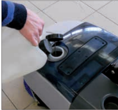
2. Befüllen Sie den Frischwassertank mit Wasser/Reinigungslösung, passend für den jeweiligen Boden und die gewünschte Reinigung.
