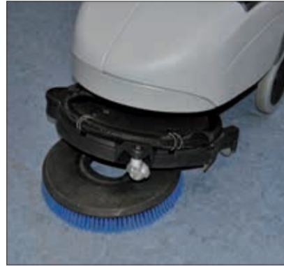
4. Platzieren Sie die Bürste unter dem Schrubdeck.
