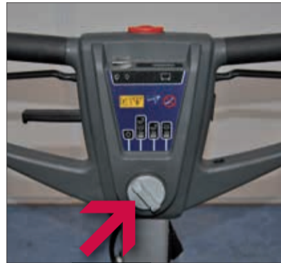
9. Drehschalter auf „0“ stellen um die Maschine auszuschalten.
