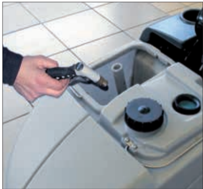
11. Reinigen Sie anschließend den Schmutzwassertank.
