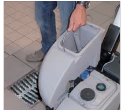
10. Nach Beendigung des Reinigungsvorgangs unbedingt den Schmutz- und Frischwassertank entleeren.
