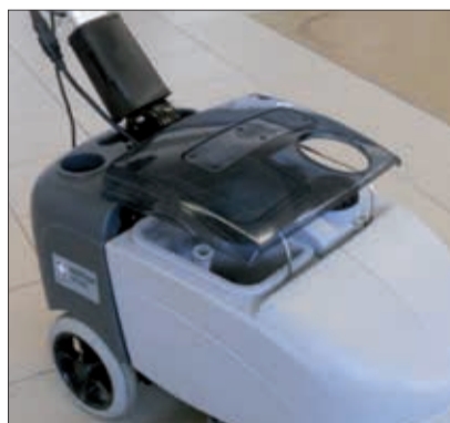
18. Parken Sie die Maschine mit geöffnetem Tankdeckel.
