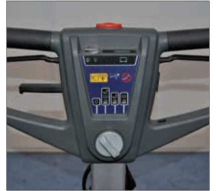
5. Drehschalter auf die gewünschte Anwendung drehen.
