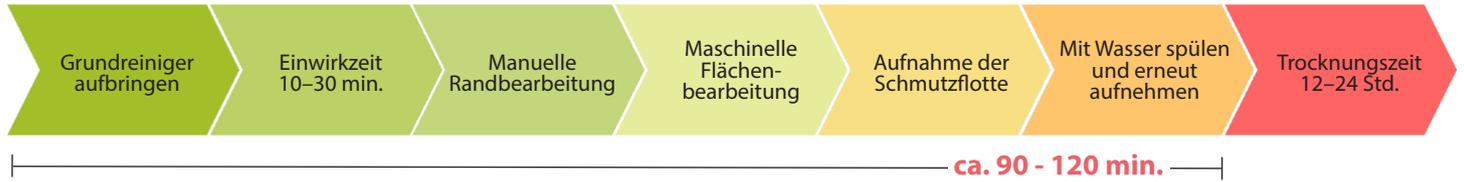
Grundreinigung trocken mittels Floor Sander und Jöst Abraflex® Maroon Pad
